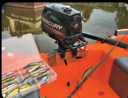
Zesílené zrcadlo pro uchycení spalovacího motoru
