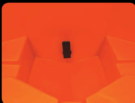
V zadním zrcadle lodi je umístěn vypouštěcí ventil
